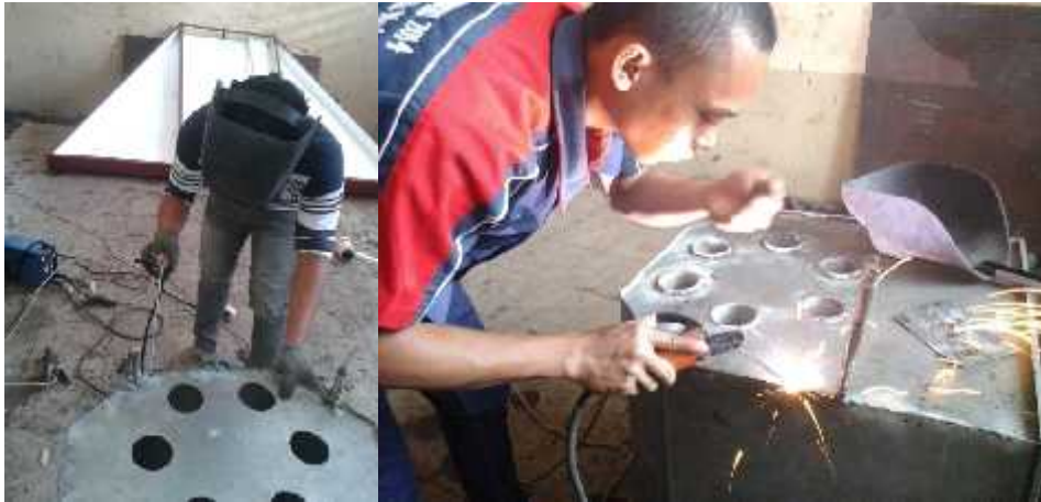
Gambar 3. Penyambungan dengan cara pengelasan pada dinding depan dan dinding belakang dengan bentuk bodi awal
