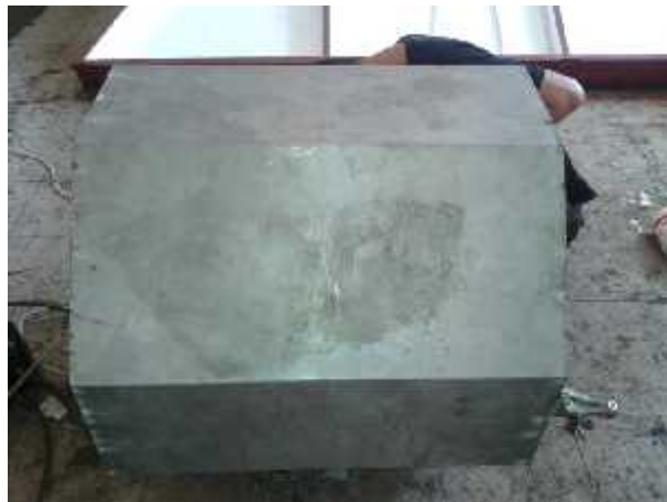
Gambar 2. Bentuk bodi awal setelah habis di bending
