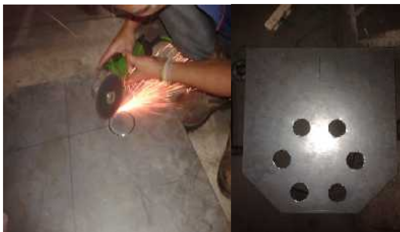
Gambar 5. Pengukuran dan penggerindaan pada bentuk pola dan ukuran yang sudah di tentukan
