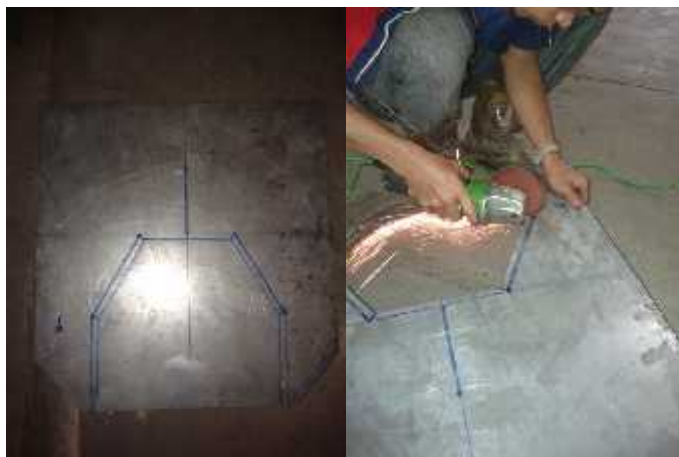
Gambar 6. Pengukuran dan penggerindaan plat untuk membuat sekat horisontal
