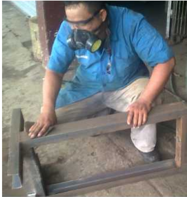
Gambar 3 .Proses Pengamplasan Rangka Pres.
