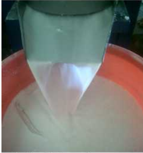
Gambar.4.8 Aliran Santan saat proses pengepresan
