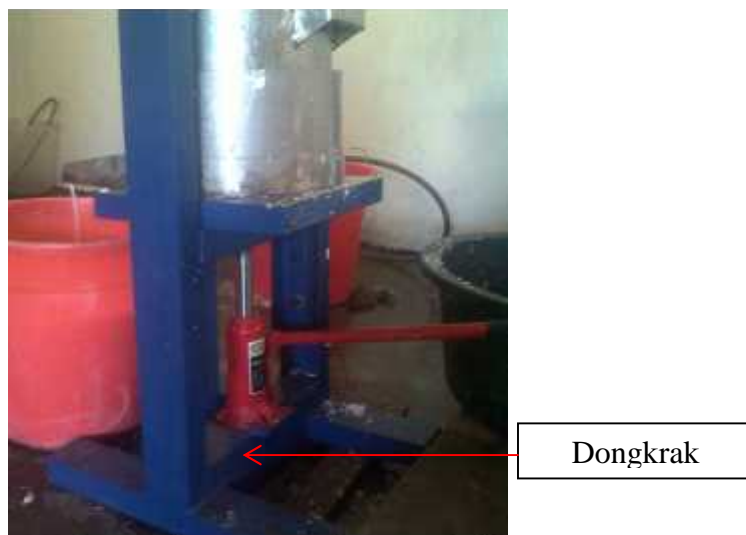
Gambar.4.7 Dongkrak yang menekan material dalam silinder press .
