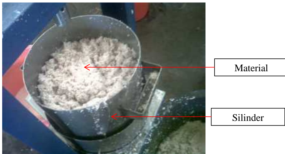
Gambar 4.5 Material dalam silinder pres.
