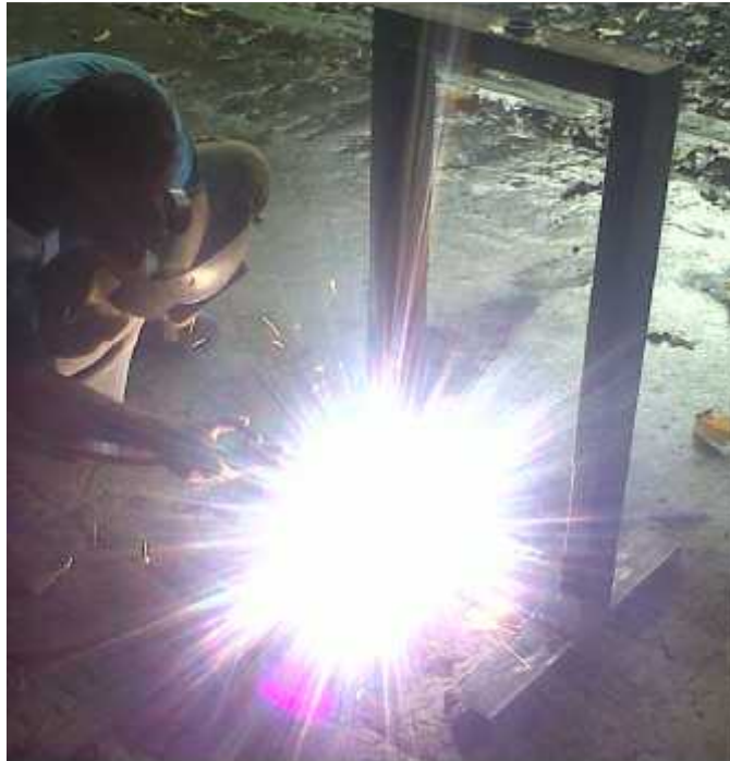
Gambar 1 .Proses Pengelasan Rangka Pres.
