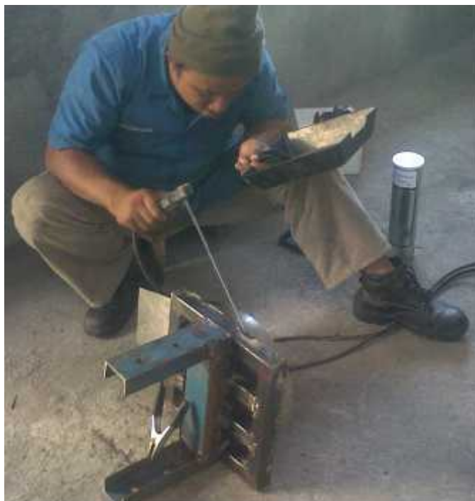
Gambar 2 .Proses Pengelasan Meja Pres
