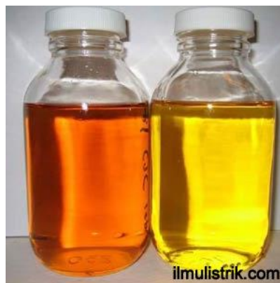
Gambar 6. Minyak Isolasi Trafo
