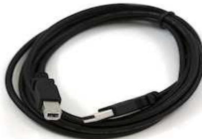
Gambar 2.4 Kabel USB board Arduino Uno
