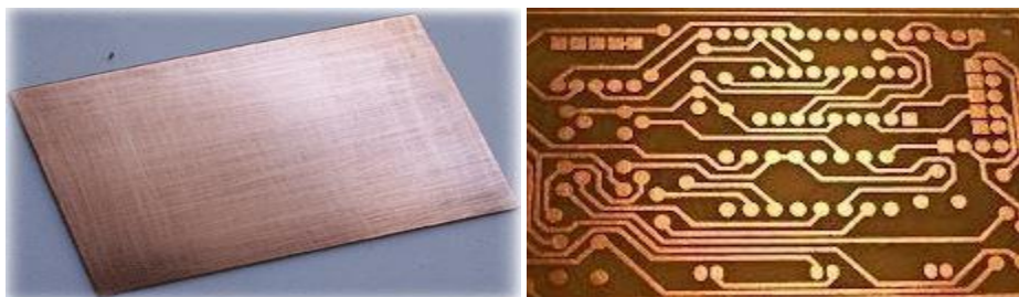
Gambar 2.15 Papan PCB kosong dan yang sudah menjadi pola.
