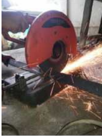
Gambar1. pemotongan besi siku L 50x50x5
