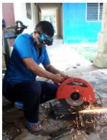
Gambar 6. pemotongan baja hollow
