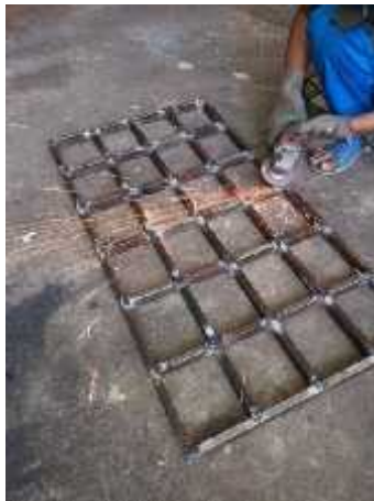
Gambar 8. penggerindaan rangka meja press
