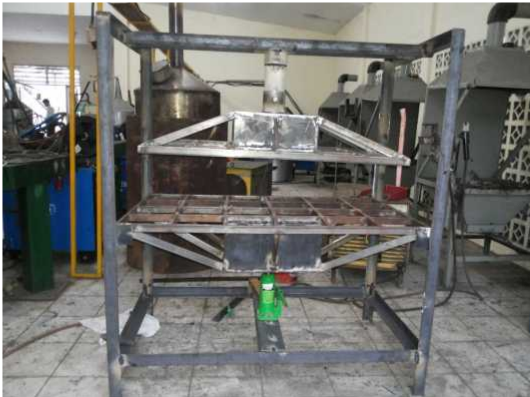
Gambar 13. alat press untuk membuat papan komposit dari sabut kelapa
