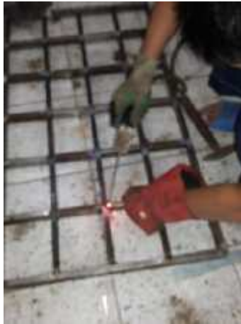
Gambar 7. pengelasan rangka meja press
