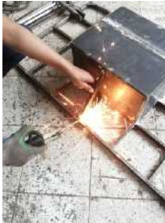
Gambar 10. penyambungan pelat dan rangka penahan meja
