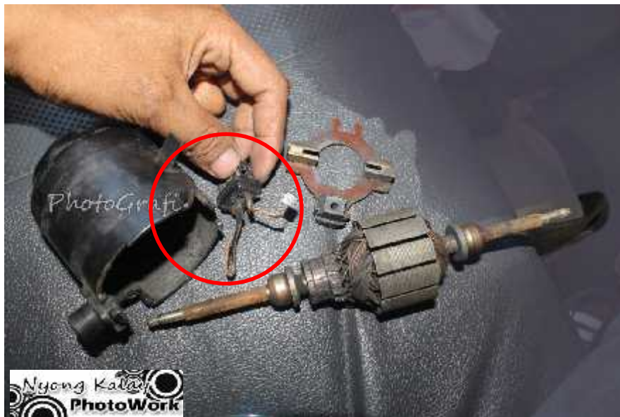
Gambar 3.8 Motor blower yang sudah tidak layak pakai
