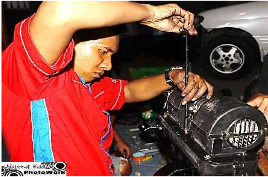
Gambar 3.19 Menyatukan kembali blower dengan evaporator
