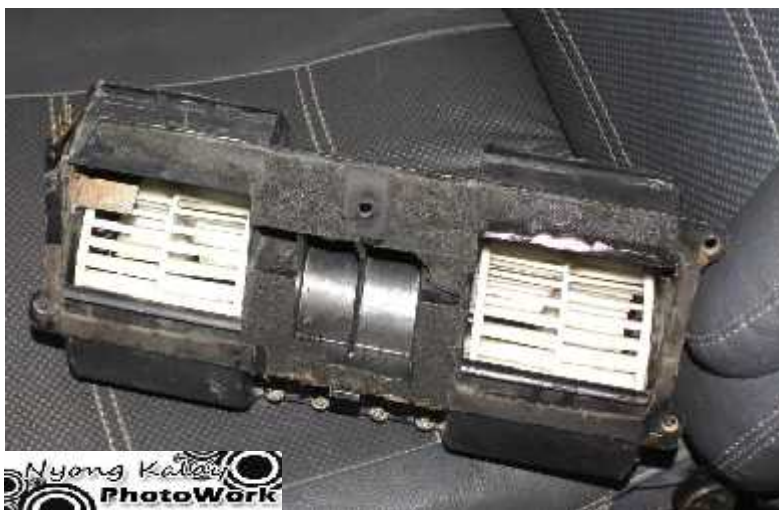
Gambar 3.12 Pemasangan kembali motor blower
