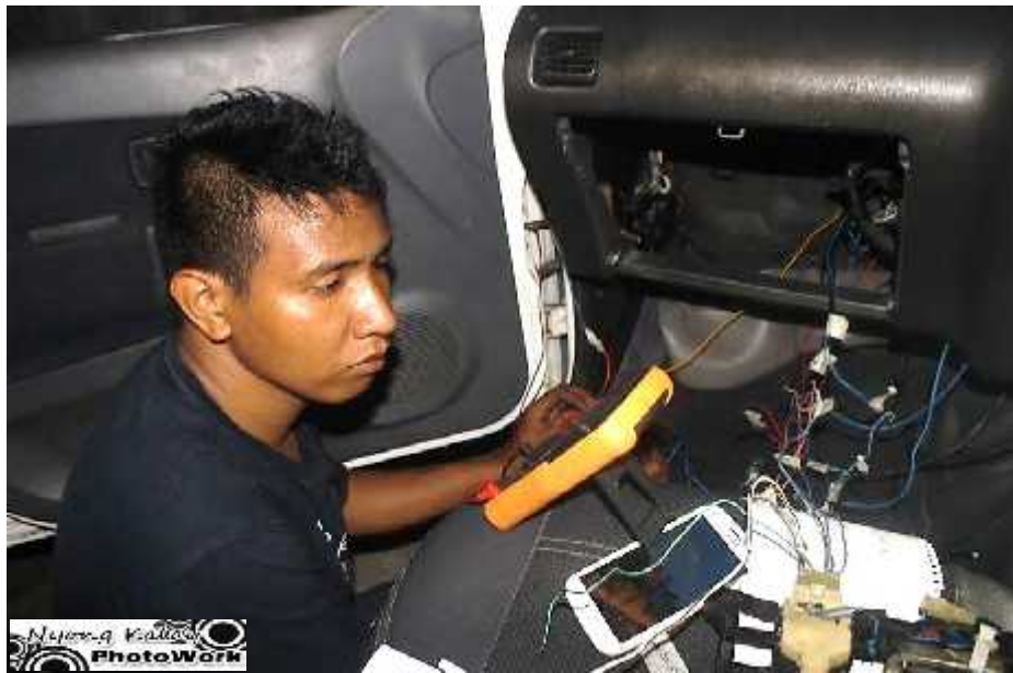
Gambar 3.15 Proses pembuatan wiring baru
