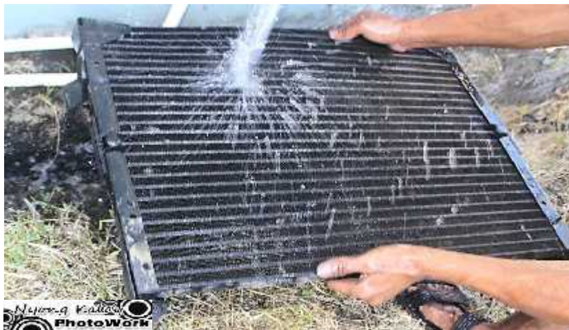
Gambar 3.23 Proses pembersihan kondenser
