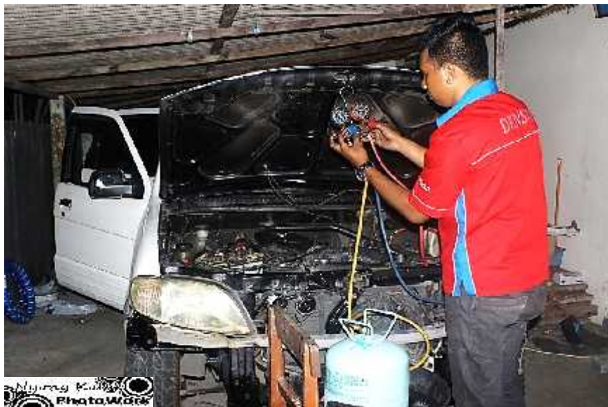
Gambar 3.34 Proses pengisian refrigerant dari sisi tekanan rendah
