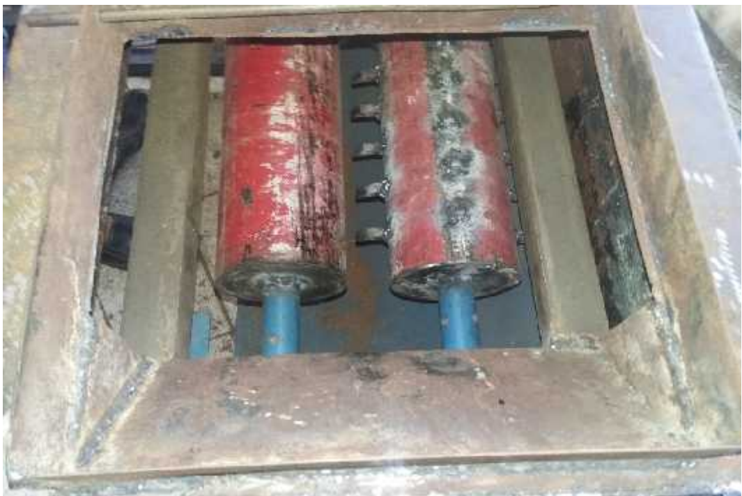
Gambar 8 Proses pengelasan pisau pengupas dan pemasangan poros pada alat
