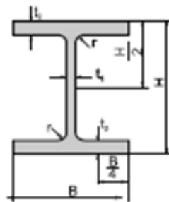
Gambar 2.1. Profil baja Wide Flange
