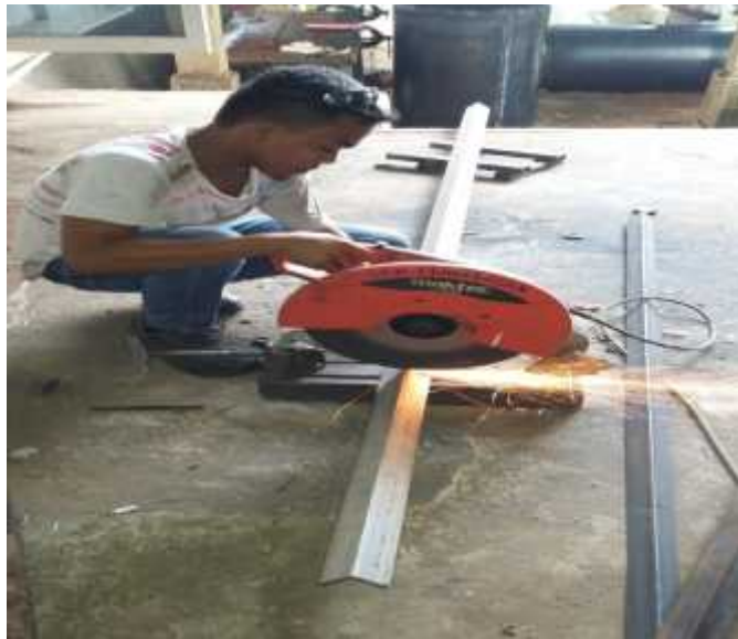
Lampiran 1. pemotongan besi siku stainless steel 50x50x5 mm untuk pembuatan rangka rak
