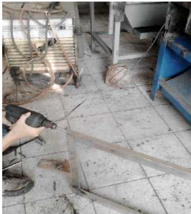
Lampiran 18. Pengeboran bingkai untuk kedudukan engsel
