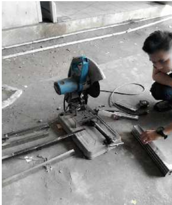
Lampiran 16. Mengukur dan memotong hollow stainless steel 40x20 mm untuk pembuatan bingkai pintu
