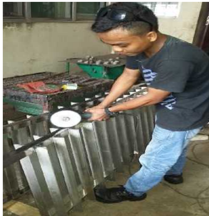
Lampiran 4. Memoles rangka rak agar terlihat mengkilat
