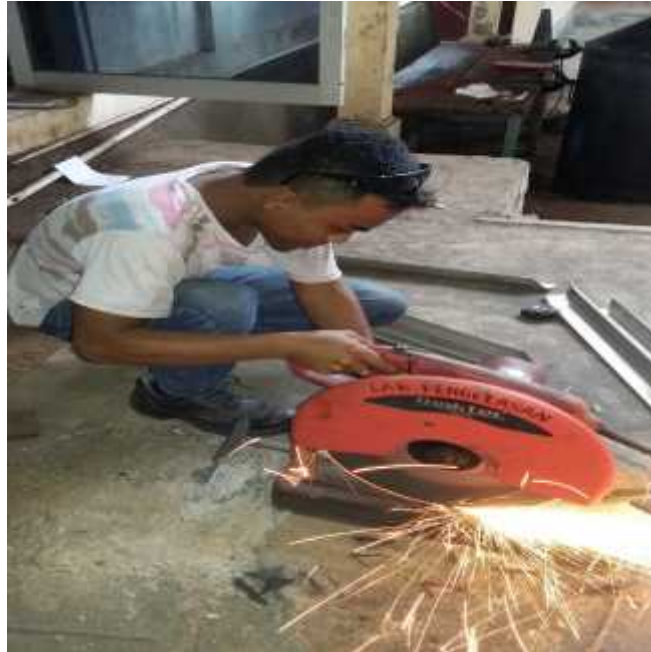
Lampiran 5. Memotong besi siku stainless steel 50x50x5 mm untuk bingkai penguat tiang
