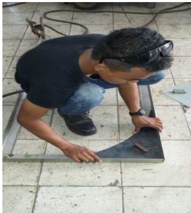
Lampiran 6. Mengukur dan mengelas bingkai penguat tiang
