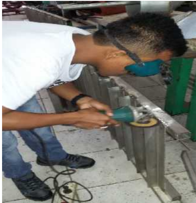
Lampiran 3. Menggurinda permukaan rangka rak
