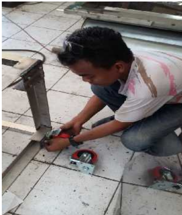
Lampiran 14. Pemasangan bola roda pada kedudukan proofer
