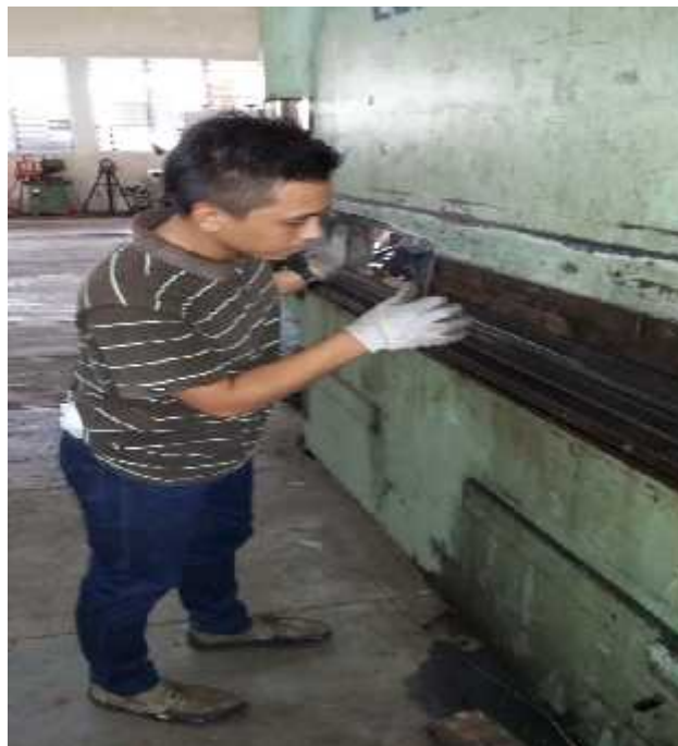
Lampiran 10. Melipat plat stainless steel 1 mm yang sudah diukur
