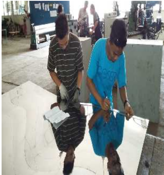
Lampiran 9. Mengukur plat stainless steel 1 mm yang akan di gunakan dibagian luar rangka proofer
