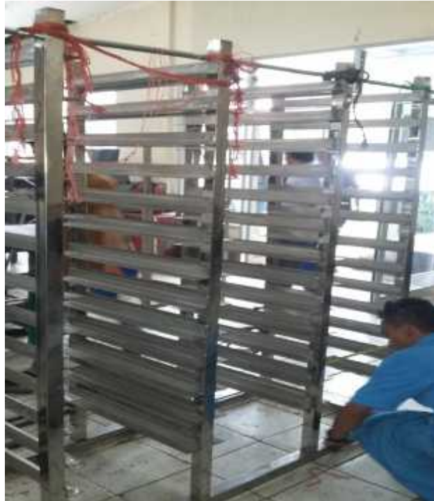
Lampiran 7. Merakit rangka rak
