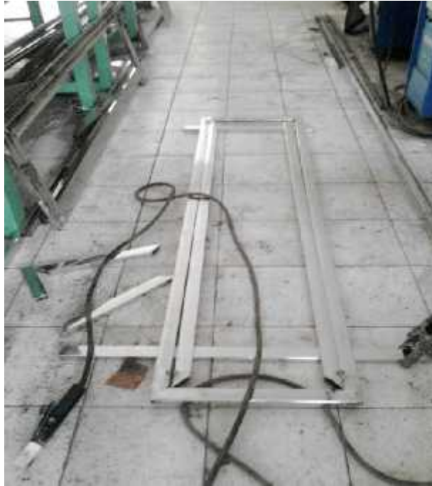
Lampiran 17. Mengelas bingkai pintu yang sudah di ukur
