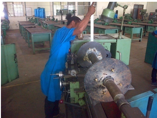
Gambar. Foto Pembuatan flens dan poros bearing
