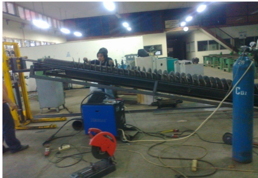
Gambar. Foto proses pembuatan turbin ulir Archimedes di Laboratorium Teknik Mesin Politeknik Negeri manado
