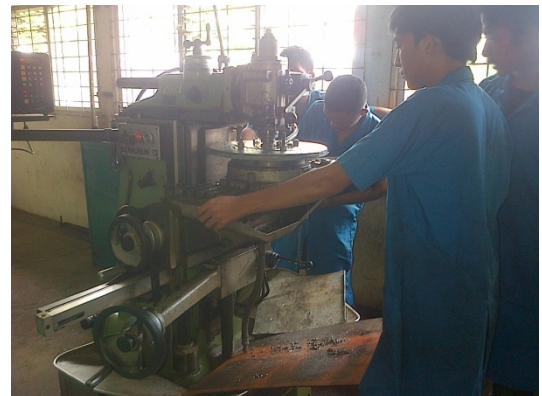
Gambar. Foto Pembuatan flens dan poros bearing
