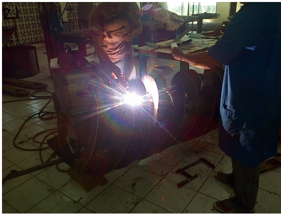
Gambar. Foto Proses Pembuatan Sudu Ulir dan Rangka
