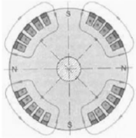
Gambar 2.15 Penampang rotor silinder pada generator
