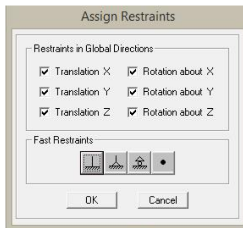
Gambar 3.22 Menentukan jenis perletakan
