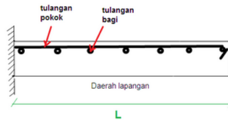
(a) Tampak depan pelat kantilever
