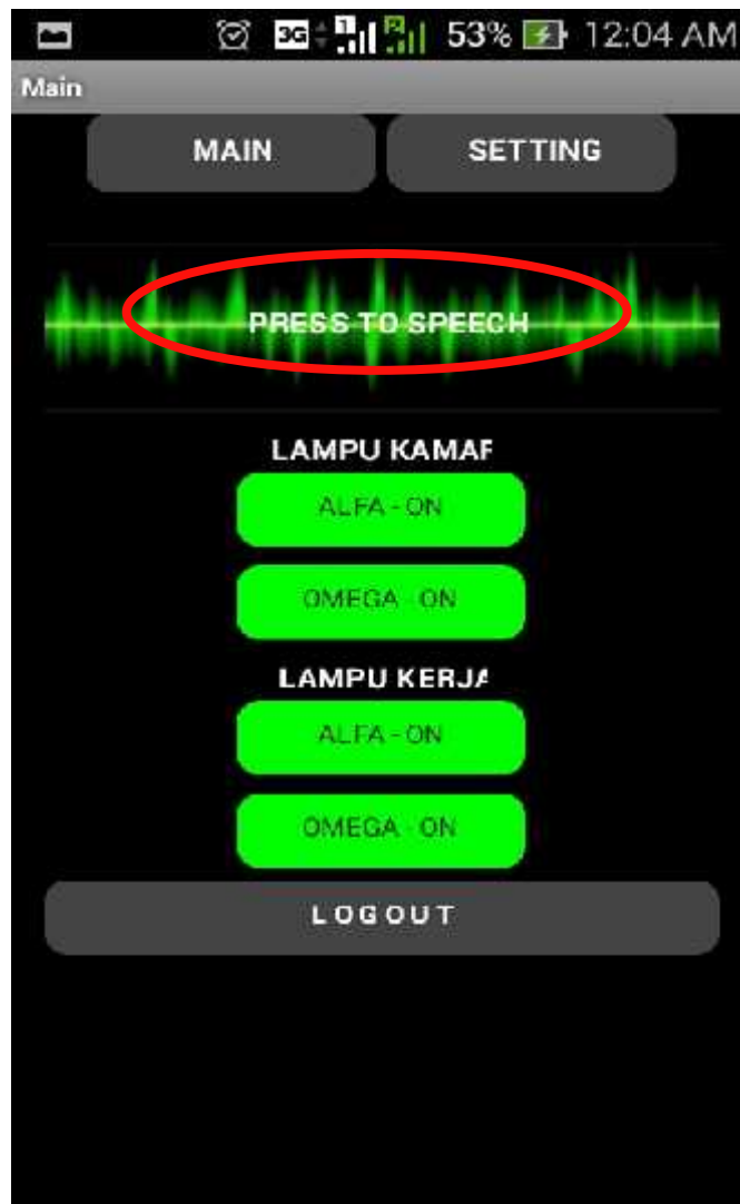
Gambar 4.10 Tombol PRESS TO SPEECH kontrol menggunakan suara (speech)
