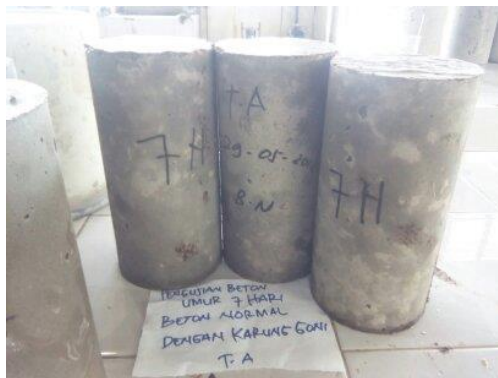
Gambar D13. Proses pemberian kode pada benda uji
