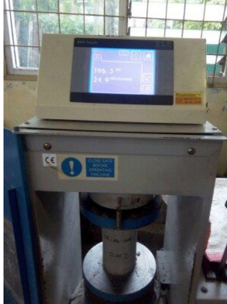
Gambar 3.14 Proses uji tekan beton
