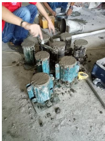
Gambar D11. Proses cetak benda uji
