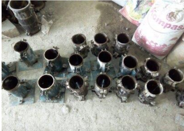
Gambar 3.18 Persiapkan wadah/cetakan silinder
