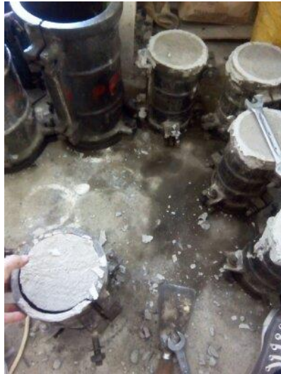
Gambar D12. Proses buka cetakan benda uji
