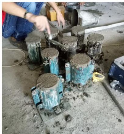
Gambar 3.24 Proses pengisian campuran beton dalam cetakan silinder
