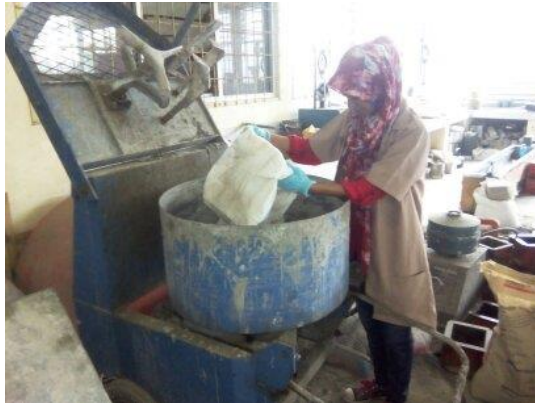
Gambar 3.20 Proses penambahan kerikil pada campuran Kemudian bahan tersebut tercampur rata masukkan air secara perlahan-lahan, seperti pada Gambar 3.21 berikut:
