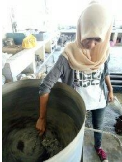
Gambar D7. Proses pencampuran semen dan pasir
