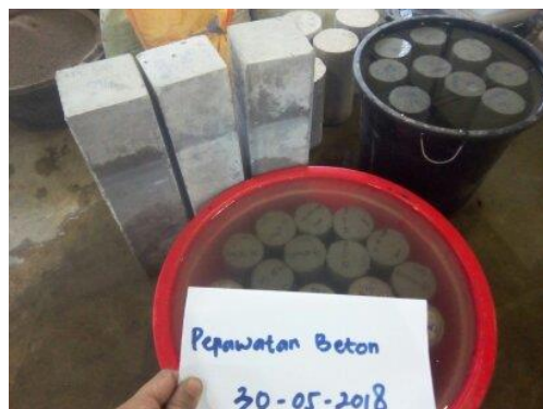
Gambar D14. Proses perawatan perendaman benda uji
