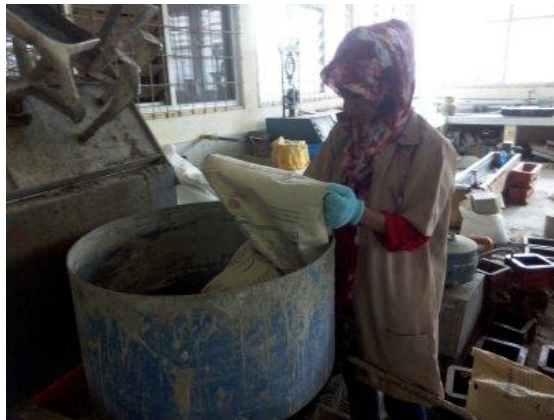
Gambar 3.19 Proses pencampuran semen dan pasir
