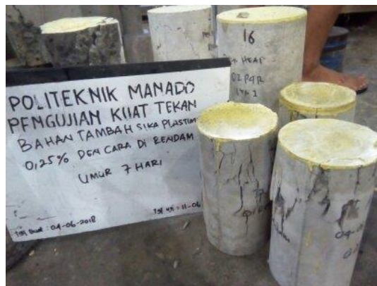
Gambar 3.32 Benda Uji retak/ hancur
