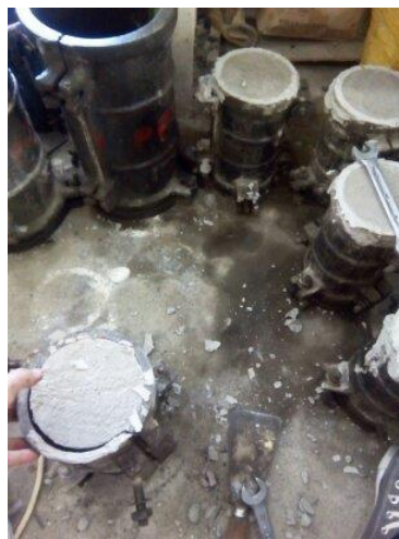
Gambar 3.25 Proses membuka benda uji dalam cetakan silinder
