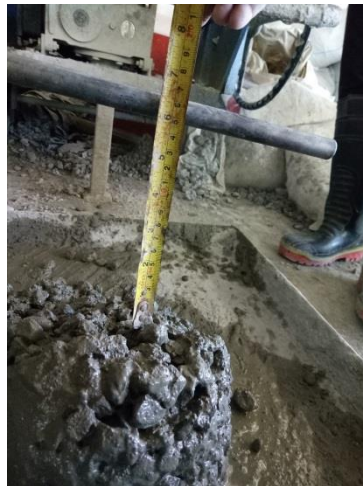
Gambar D10. Proses slump test
