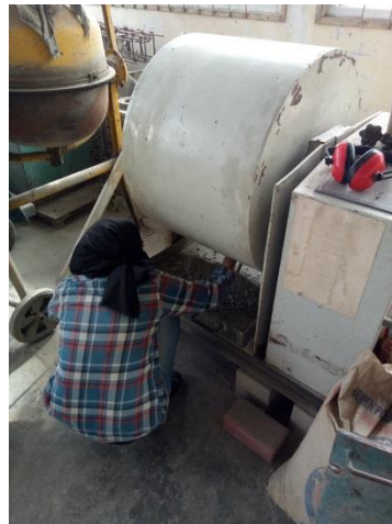
Gambar 3.11 Proses mengeluarkan benda uji dari mesin Los Angele
