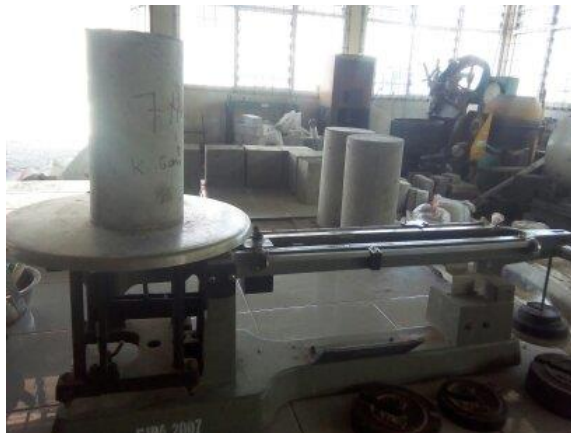
Gambar D16. Proses timbang benda uji
