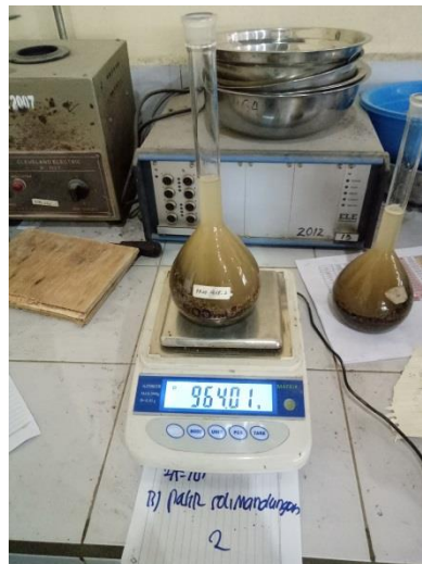
Gambar 3.4 Piknometer dan benda uji
