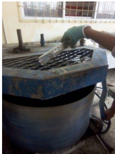
Gambar 3.22 Proses penambahan Sika Plastiment-VZ pada campuran
