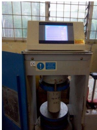
Gambar D17. Benda uji diletakkan pada mesin tekan
