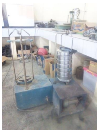
Gambar 3.9 Proses ayak agregat halus
