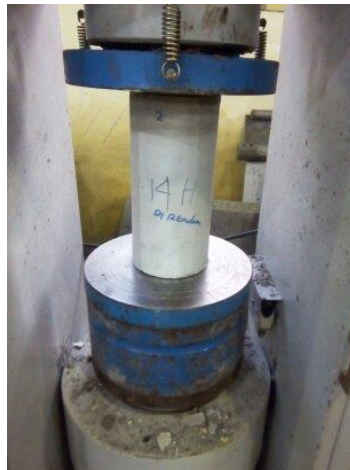
Gambar 3.30 Proses uji tekan beton
