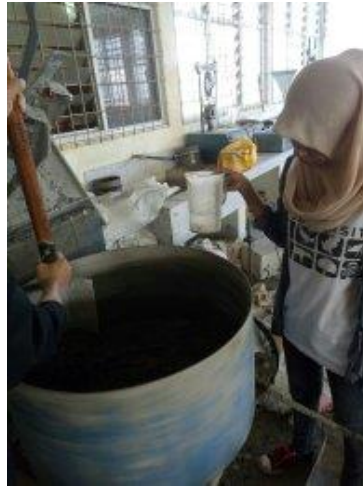
Gambar D9. Proses penambahan air pada campuran
