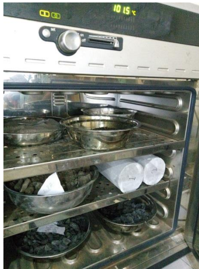
Gambar 3.5 Proses pengeringan benda uji dalam oven
