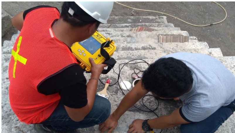
Pengujian UPV pada bangunan Masjid Al-Muhajirin
