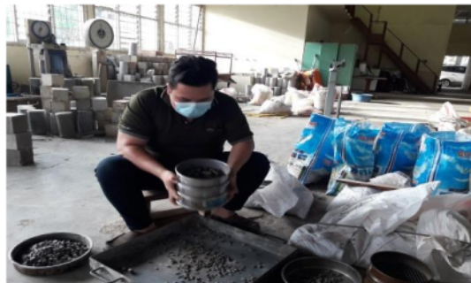
Gambar 2. Pengujian Abrasi di Lab. Uji Bahan Politeknik Negeri Manado
