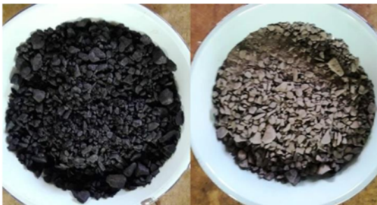
Gambar 3. Pengujian Ekstraksi CPHMA-Sebelum dan Sesudah Ekstraksi
