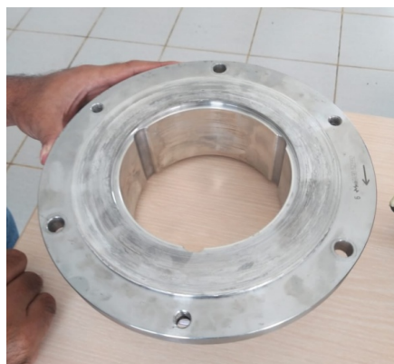
Gambar 4. Bantalan Turbin yang mengalami aus
