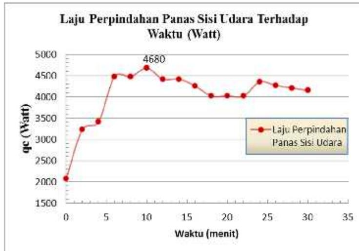
Gambar 4 Grafik laju perpindahan panas sisi udara radiator terhadap waktu
