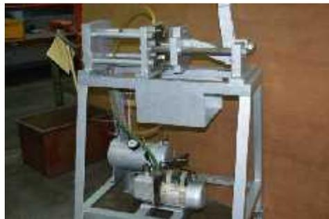
Gambar 5 Alat Cetak *manual vacuum hpdc*
