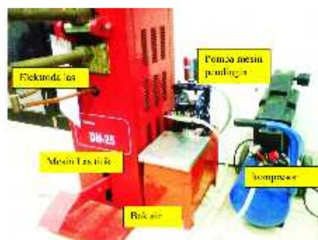
**Gambar 3. Modifikasi Mesin pendingin pada Mesin las titik Stationer**
