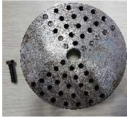
GAMBAR 1. PIRINGAN MILD STEEL DENGAN MASSA UNBALANCE
