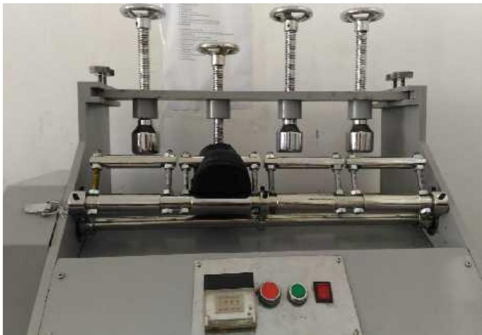
**Gambar 2. Uji keretakan sol dengan *Shoe Bending Tester***
