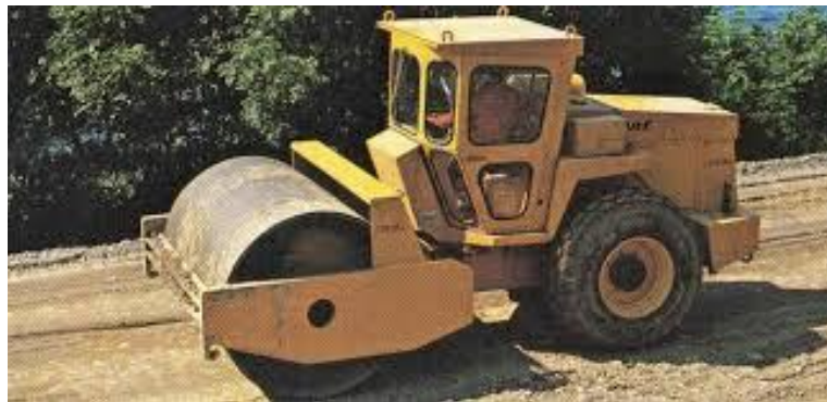
Gambar 3.7 pemadatan lapisan perkerasan menggunakan vibration roller Sumber: (Ndayun, 2014)
