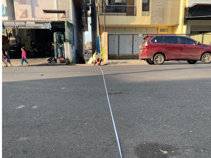
Gambar I-1 Pengukuran Lebar Jalan
