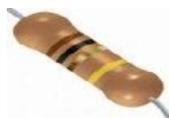
**Gambar 2.18** Bentuk fisik Resistor
