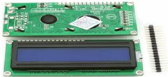
**Gambar 2.13** Bentuk fisik LCD16x2
