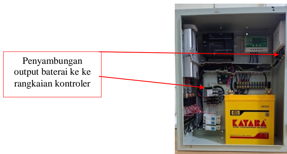
Gambar 12 Peyambungan Output Baterai ke Rangkaian Kontroler
