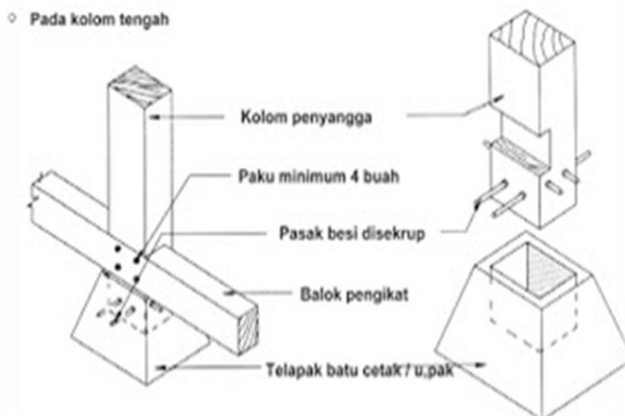
Gambar 2.2 Pondasi Telapak
