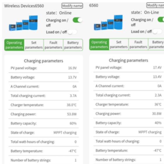
Gambar 4.11 Pengukuran parameter PLTS pada jam 08.00 dan 09.00 Tanggal 15 September 2024
