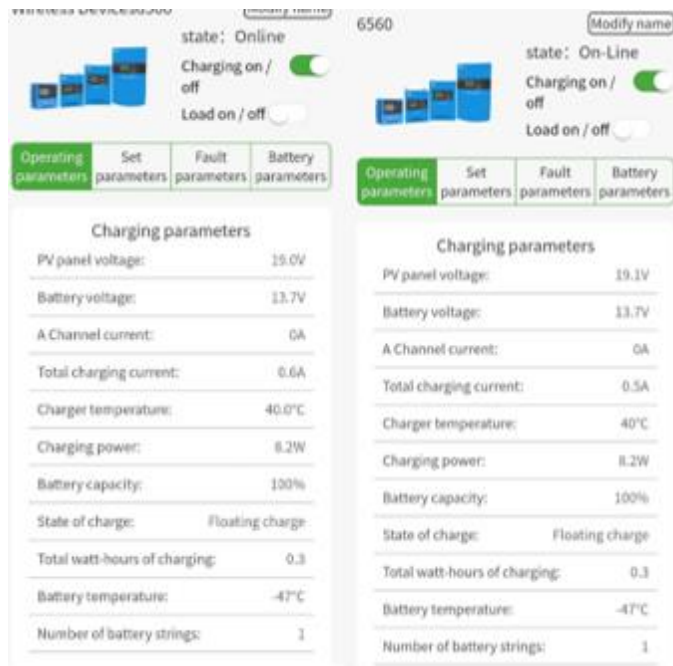
Gambar 4.4 Hasil pengukuran parameter PLTS pada jam 12.00 dan 13.00 wita
