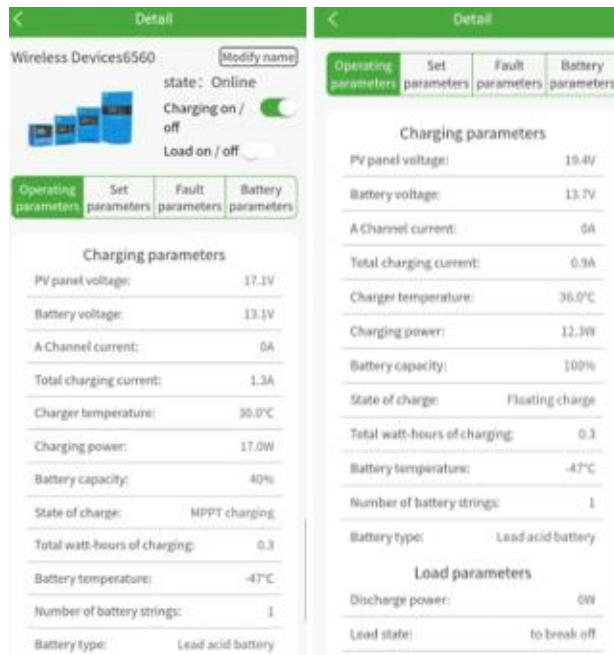
Gambar 4.2 Hasil pengukuran parameter PLTS pada jam 08.00 dan 09.00 wita
