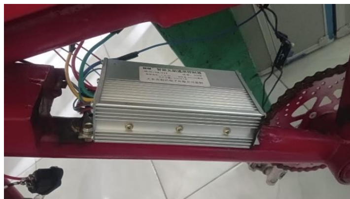
Gambar 3.15 Dudukan controller sudah di pasang
