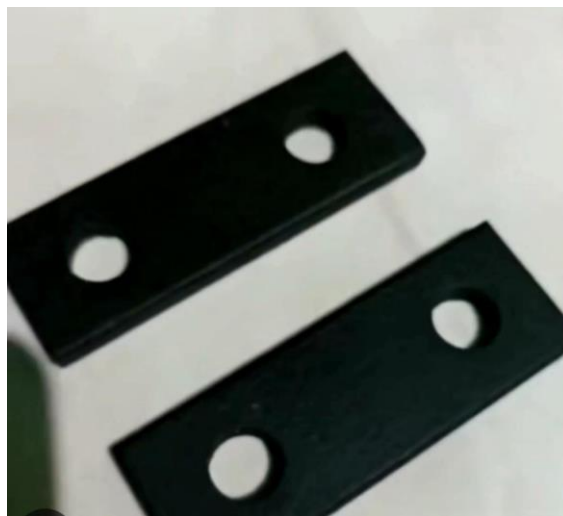
Gambar 3.13 pemotongan besi serbaguna sebagai dudukan controller
