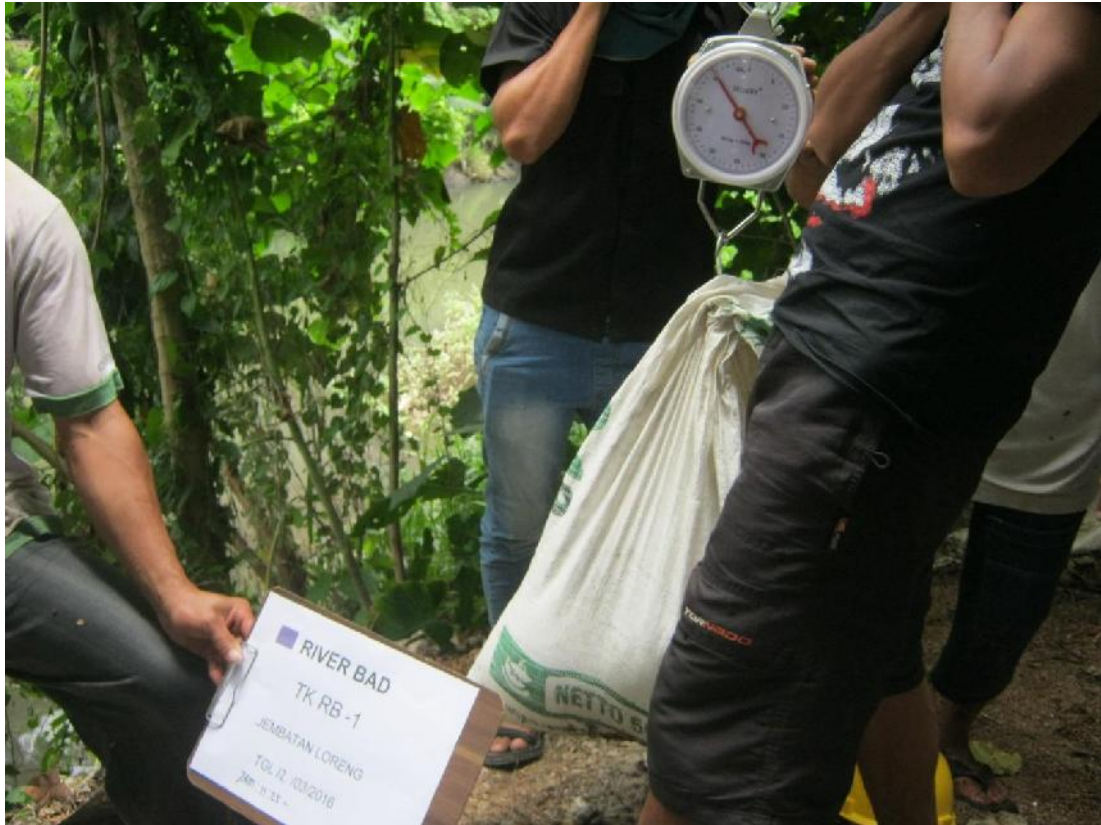
Gambar 3.4 Sampel yang telah di timbang 30 kg
