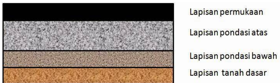
Gambar 2.2 Susunan Lapisan Perkerasan Lentur
