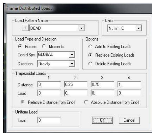
Gambar 12. Gambar beban yang bekerja pada balok
