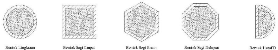
Gambar 17. Bentuk Pondasi Sumuran
