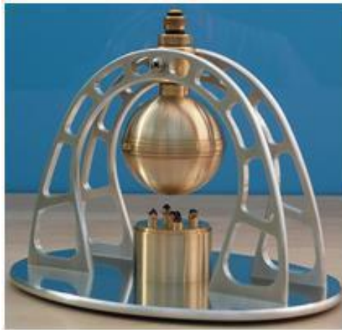
GAMBAR 2.1 Mesin uap Aeolipile
