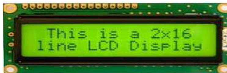
Gambar 2.12 Bentuk fisik LCD karakter 16x2
