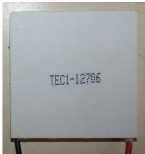
Gambar 2.5. Bentuk Thermo-Electric (TEC) yang ada di pasaran
