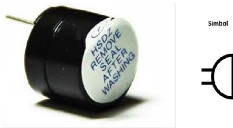
Gambar 2.10. Fisik Buzzer/Alarm beserta Simbol
