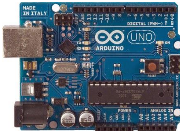
Gambar 2.3 Bentuk fisik Arduino UNO R3
